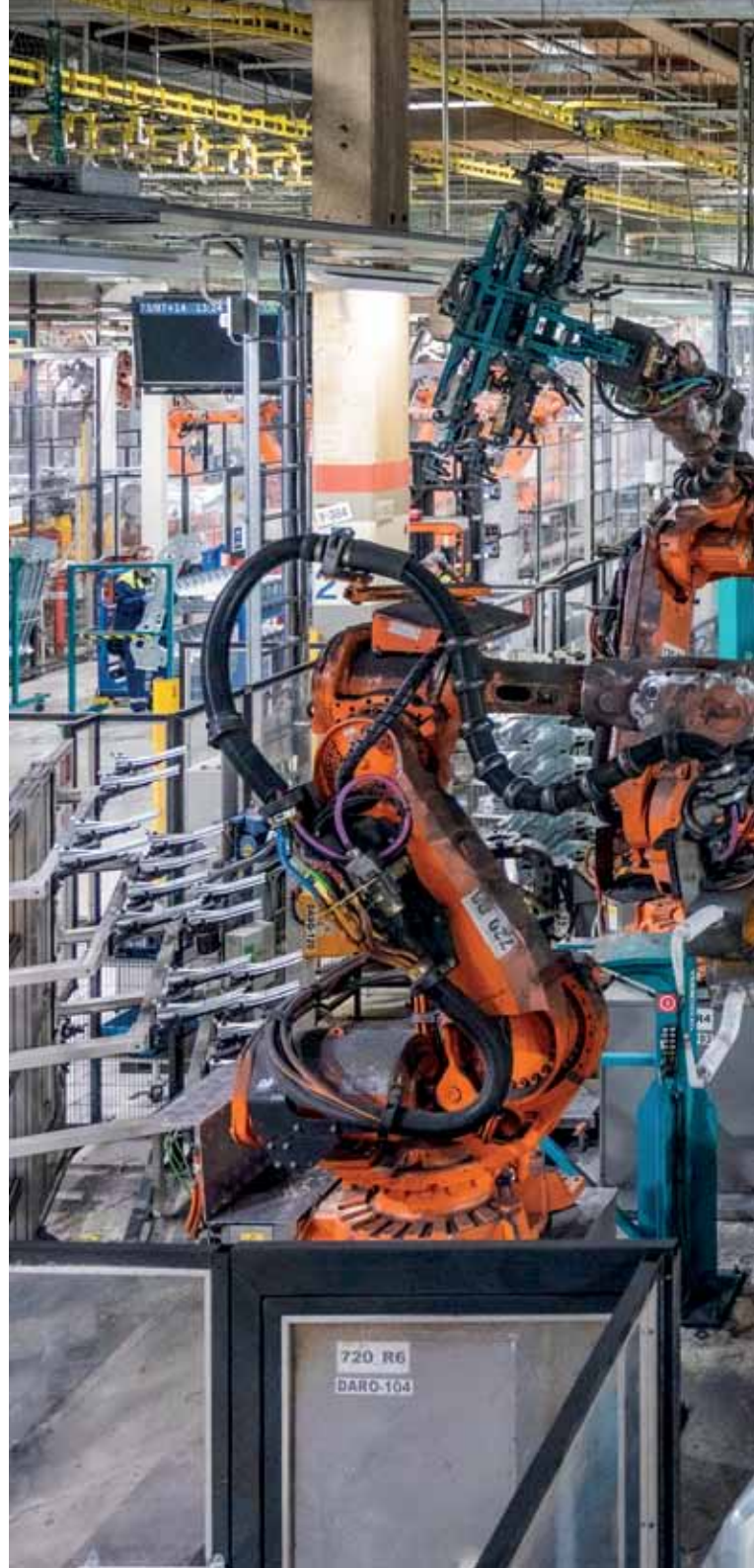
Hitsausrobottiasema Valmet Automotiven tehtaalla Uudessakaupungissa.
