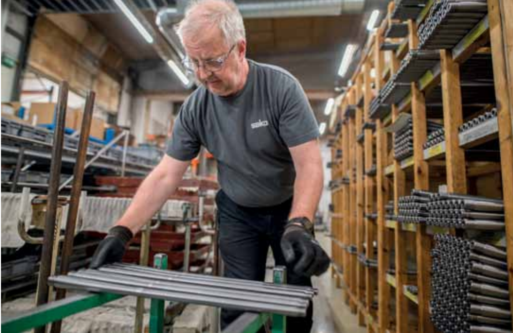
Tuotantotyöntekijä Marko Lindberg kehyksen ja piipun esikiinnivedossa Sakon asetehtaalla Riihimäellä.
